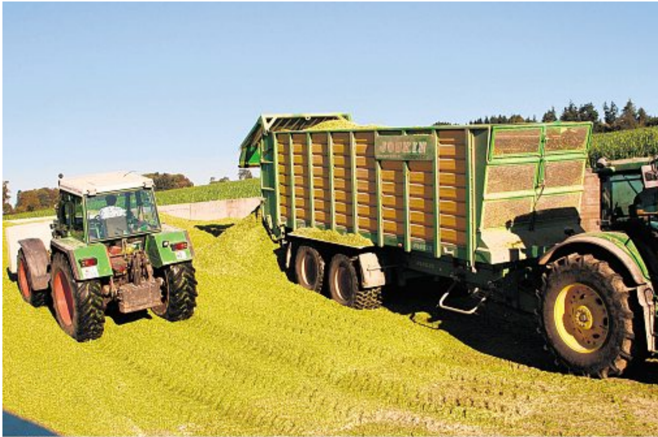
Die Walzfahrzeuge sind oft nicht mitgewachsen mit der Schlagkraft der Erntekette. Silageverluste sind die Folge.
